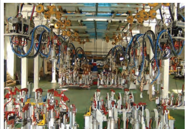
수동 Portable 라인 2 / Manual portable welding line 2
